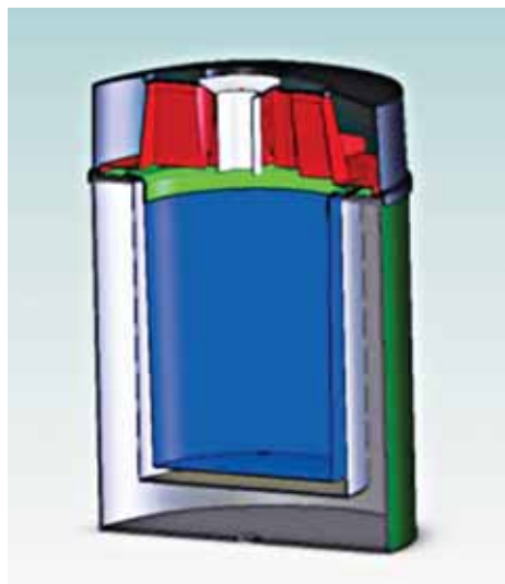
Průřez bezpečnostním košem BlastGard a jeho reálná podoba
